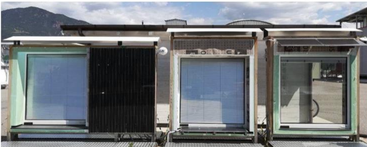
Figura 3: I tre prototipi del “Solar Window Block” con le tre diverse configurazioni (modulo fotovoltaico in verticale, a davanzale e su aggetto) durante la fase di test presso il laboratorio “PV Integration Lab” di Eurac Research al NOI Techpark di Bolzano. Credits: Eurac Research
