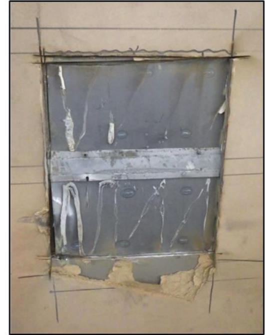
**Foto della prova di resistenza all'azione manuale di effrazione con attacco dal lato esterno secondo la norma EN 1630:2016**
